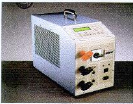
Fig. 2 - Banco de resistencia utilizado como descargador del conjunto de acumuladores en un ensayo de descarga.
