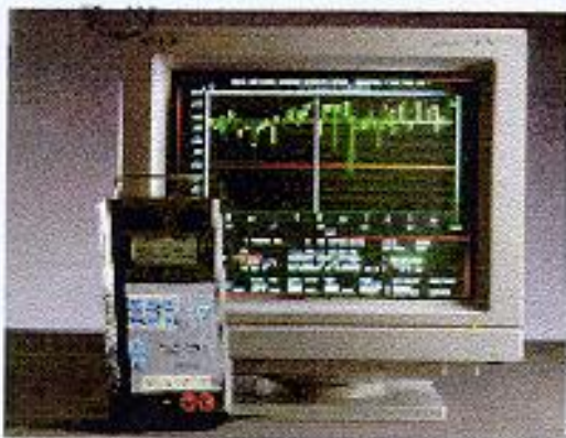
FIG. 3 - Instrumento de medición de tensión de acumuladores, con memoria; que permite transferir directamente al computador los datos para ser procesados y determinar así la perspectiva de vida de un acumulador.
